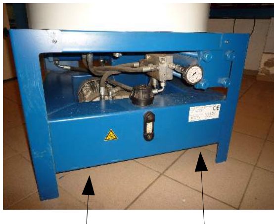
Aufnahmeposition für Gabelstapler oder Hubwagen
